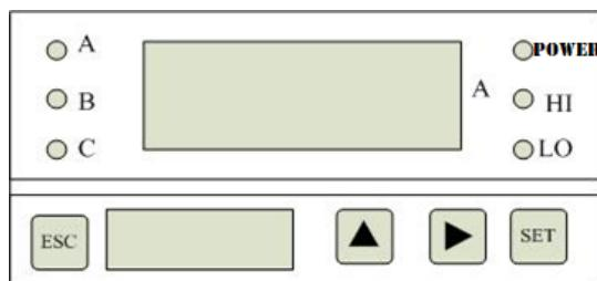
大窗口显示被测电流，小窗口显示电流整定值。POWER-电源指示灯，HI-过电流指示灯，LO-欠电流指示灯，A、B、C 指示当前显示电流来源。
